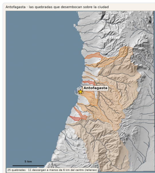
Antofagasta. Las 23 quebradas que desembocan sobre la ciudad; las rellenas descargan a menos de 6 km del centro. Por ellas bajaron los flujos del 18 de junio de 1991.
